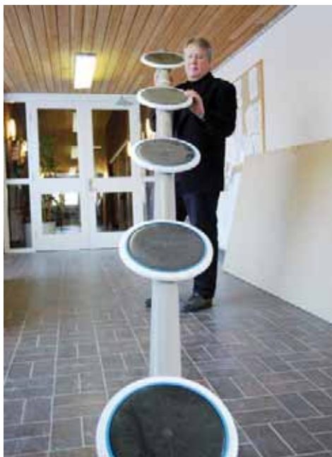
Roland Johansson visar luftningssystemet gummimembrandysor som installeras i den nya biologiska reningen.
