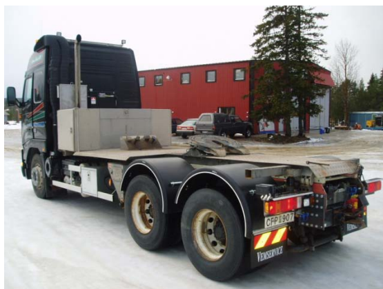
Dragbil med s.k. Laxå-fäste, där vändskivan är monterad
