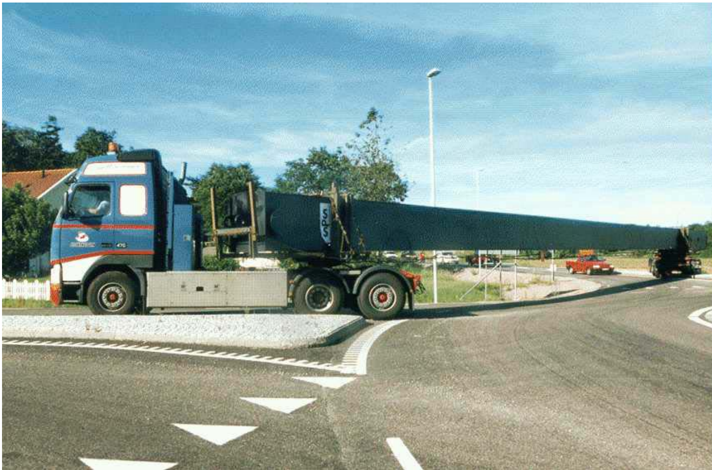
Transport med lastbil och s.k. balkvagn. Fordonen är förbundna med den gemensamma lasten.
