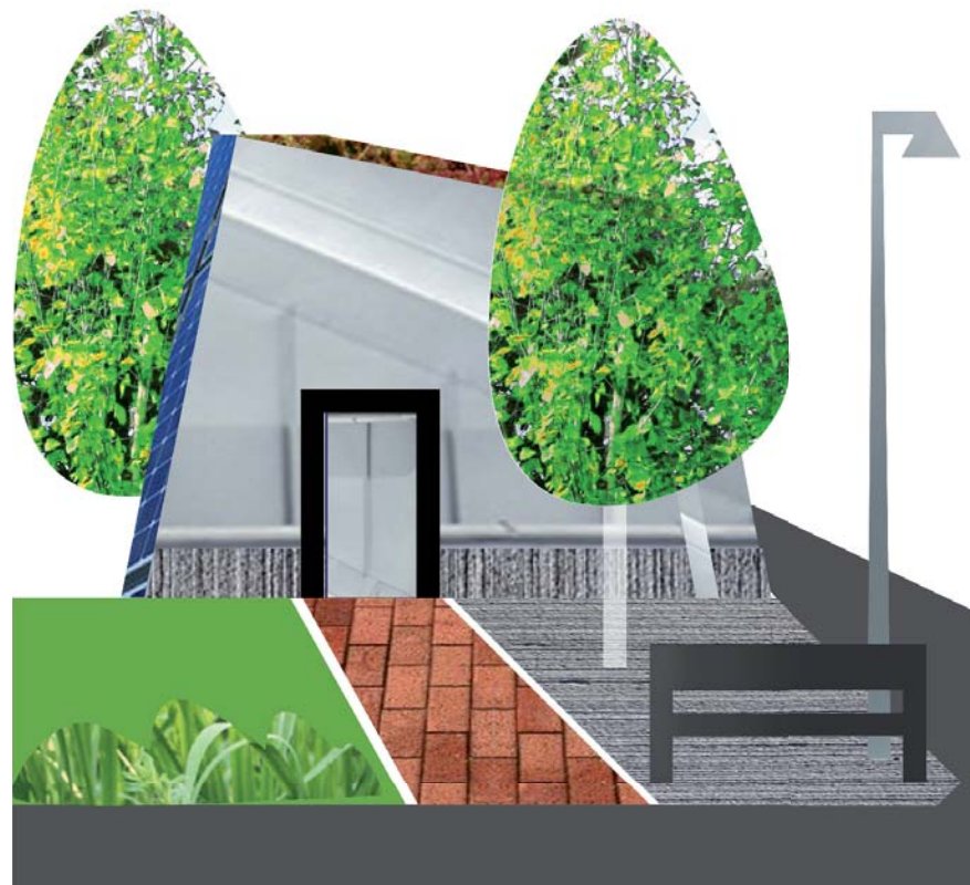
Alu-zink fasad och dörr. Detaljer i svartlackerad plåt. Rött tegel mot grått grus.
