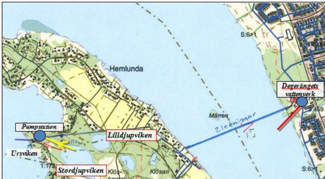
Figur 5. Översiktsbild över befintligt råvattenintag och pumpstation från huvudvattentäkten och Degerängets vattenverk. Blåa ledningar är ordinarie intagsledningar röd ledning är reservintagsledning.
