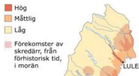
Figur 12. Översiktlig riskbedömning för skred och ras (SGI 2008).
