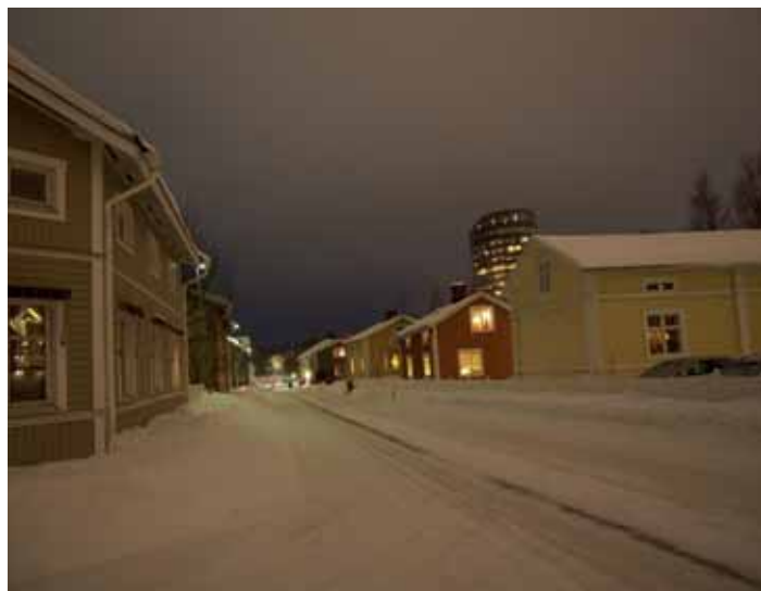
Befintligt ljus korsning Malmgatan/ Repslagaregatan. Här saknas en stolpe, platsen upplevs mörk. På bilden syns även kvicksilverljuskällans dåliga färgåtergivning.
