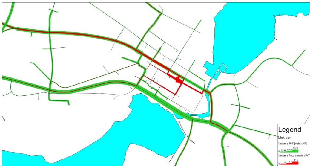
Illustration över ökad belastning (röda linjer) på trafiksystemets befintliga flöden (gröna linjer) med avseende av Häggen respektive Löjan.
