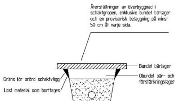
Figur 2. Tvärsektion på första återställningen
